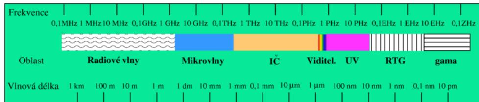
Obrázok 2.3: Elektromagnetické spektrum prevzate z [12]
