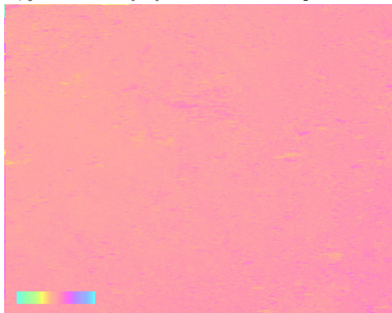
Obrázek 2: Západní část severočeské hnědouhelné pánve (deformační interferogram) — příklad správného rozbalení fáze. Není zde žádná hrana, přechod je tak pozvolný, že není vidět. Není zřejmé, zda jsou dobře rozbaleny barevné „fleky“, je však jisté, že nejsou chybná celá velká území.
