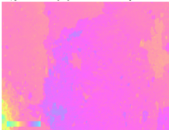
Obrázek 3: Severočeská hnědouhelná pánev (deformační interferogram) — příklad nesprávného rozbalení fáze. Je zde hrana, která zde být nemá, protože proužky v horním obrázku naznačují „spojitost“ (ve velkém) fáze. Tyto proužky by v deformačním interferogramu být neměly a poukazují na nesprávně určenou polohu družic.
